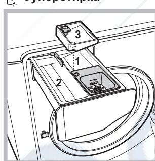
Благодаря использованию большего объема воды в начале цикла и большей продолжительности эта функция обеспечивает оптимальную стирку. Эта функция служит для удаления наиболее трудных пятен. Может использоваться как с отбелителем, так и без него. Если требуется произвести также отбеливание, вставьте дополнительный прилагающийся дозатор 3 в ячейку 1.
